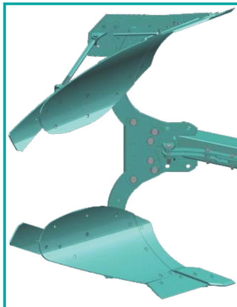
Podpora łap. W wersji z hydrauliczną regulacją szerokości roboczej, regulacja belki przenoszącej jest umieszczona po stronie lemiesza, aby zmniejszyć ogólny wymiar podczas orki przy granicy.
