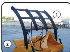
Rama pchająca i tylna pokrywa hydrauliczna
